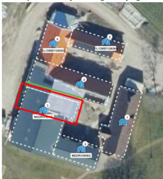
Kort 1: Ejendommens bygninger iht. BBR. Rød markering viser resterende del af bygning 3 der ønskes nedrevet. Grøn linje markerer gavl på bygning 4 der blotlægges ved det ansøgte. Gavlen vil blive bygget op som vist af billede 3. Øvrig del af bygning 3 samt bygning 2 er godkendt nedrevet i tidligere sag på ejendommen.
